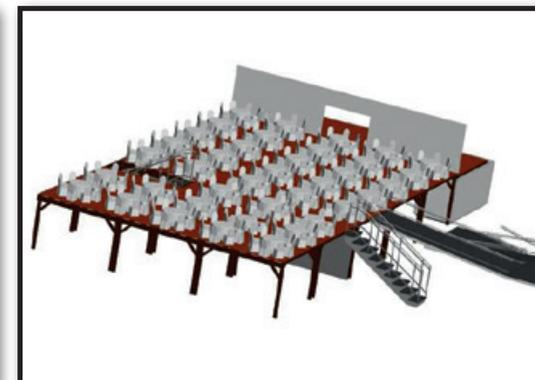
Die Treppen oder Rampen können individuell aussen- oder innenliegend gebaut werden. Beispiel: Hochbau von 15 x 25 Meter, der Gastrobereich wird über zwei Etagen betrieben.
